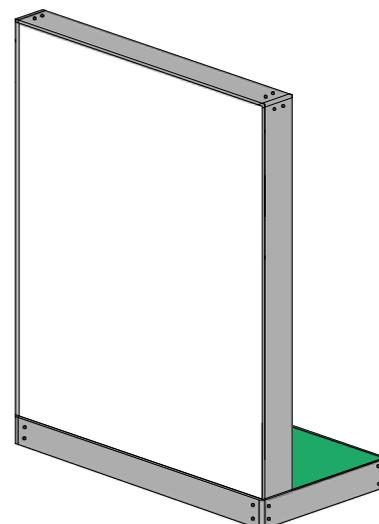
Inserire i pannelli (g) ed infilare nelle fresate i copriguida (c) nel verso indicato dalla figura. Applicare ai 2 montanti (f) gli angolari ed infine unire il montante (b) rimanente all'insieme.
