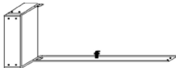
Congiungere i 4 angolari (con foro filettato (a)) con i montanti con piastra (d) e senza (b), posizionando il pannello liscio (e) come da figura. Al termine dell'operazione avvitare i piedini.
